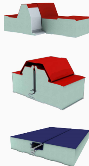
Figura 5. Ejemplo de junta de un panel de cubierta con tapa junta y mas.
