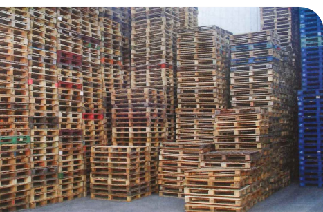
Figura 16. Almacenamiento de pallets de madera próximos a un cerramiento mediante paneles sandwich.
