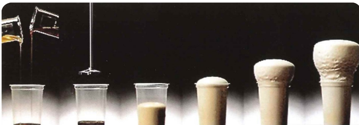
Figura 6. Reacción química del poliuretano. (Fuente Kingspan)
