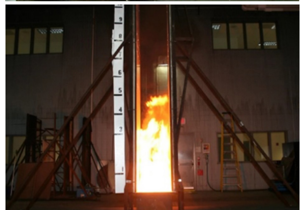
Figura 11. Ensayos de escala intermedia, de paneles paralelos (4,9 m de alto)
