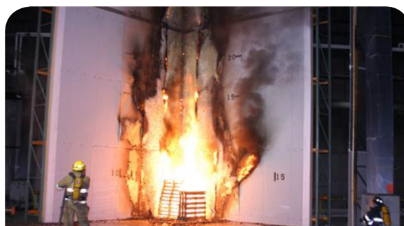
Figura 9. El ensayo de esquina de 50 pies para edificios de gran altura.
