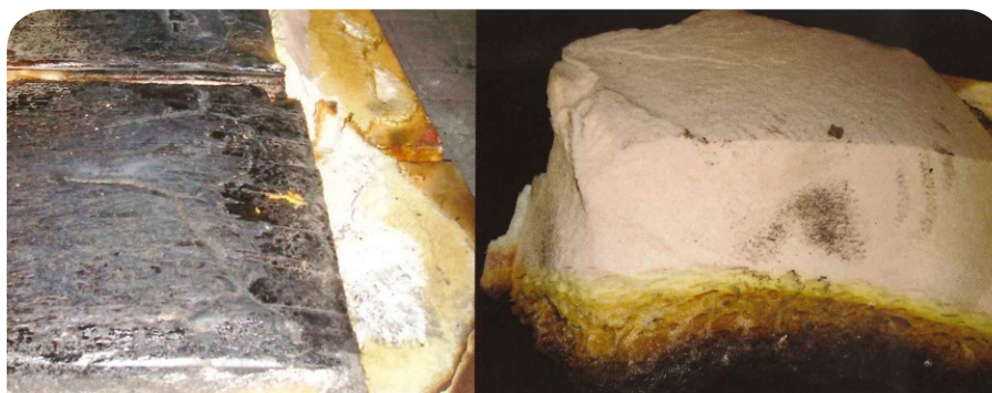
Figura 13. Ejemplo de la extensión de la carbonización sobre espuma rígida de poliuretano.
